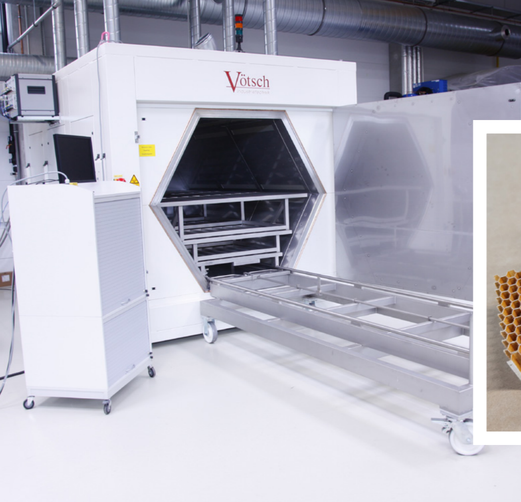
Mit Hilfe von mikrowellenunterstützten Solvolyseprozessen können aus Aramidwaben Kurzfasern zurückgewonnen werden. //
